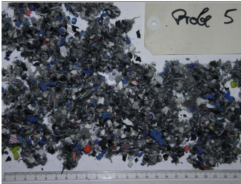
Abb. 2.2: Zerkleinerungsprodukt Schneidmühle RETSCH (10 mm Sieb), Probe 5
