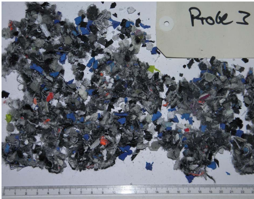
Abb. 1.3: 3. Mahldurchgang Schneidmühle SIMA (Siebloch 10 mm), Probe 3
