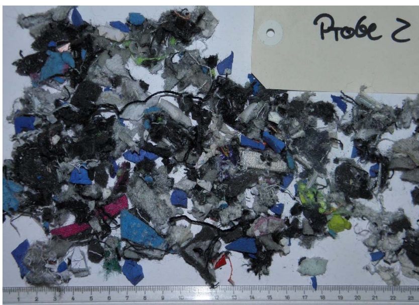
Abb. 1.2: 2. Mahldurchgang Schneidmühle SIMA (Siebloch 20 mm), Probe 2
