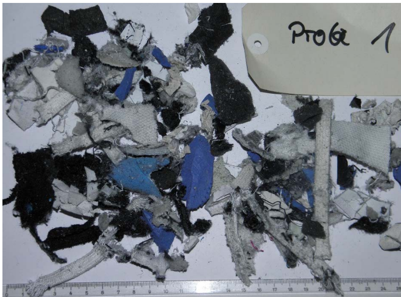
Abb. 1.1: 1. Mahldurchgang Schneidmühle SIMA (Siebloch 30 mm), Probe 1
